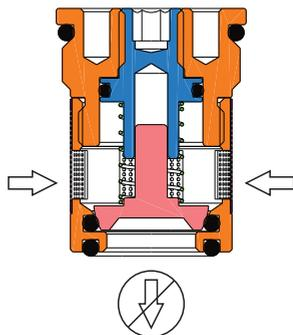
При снижении внешнего давления воды клапан закрывается.
